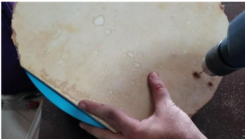
Taladrar huecos para colocar los tornillos que sostengan los soportes metálicos
