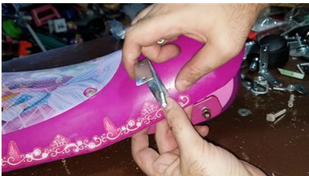
Soporte metálico en la parte trasera, debe colocarse uno a cada lado
